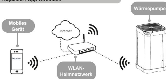
Über die iAqualink+™ App kann die Wärmepumpe per Fernzugriff mit einem Smartphone oder Tablet gesteuert werden (für iOS und Android erhältlich). Vor Herstellung einer Verbindung mit der iAqualink+™ Folgendes beachten:
