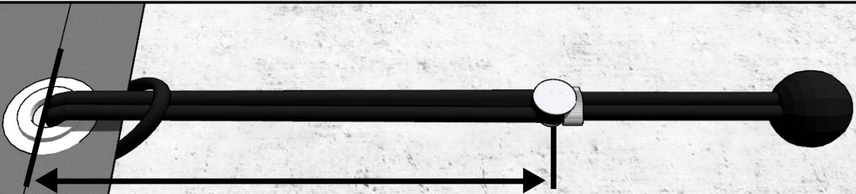
**2** Führen Sie das Gummi wie unten gezeigt durch die Öse. Als Spanngriff dient eine am Ende des Gummis angebrachte Kugel.
