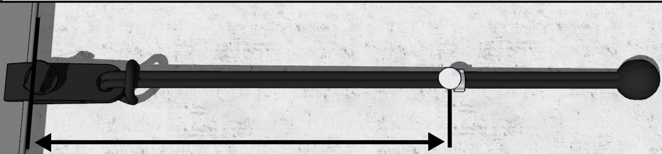
**2** Wir haben die "Krokodilklemme" an der Seitenkedra angebracht. Lösen Sie dazu die Einstellschraube und reduzieren Sie die Klemmung der Zähne. Ziehen Sie die Schraube nach dem Anbringen der „Krokodilklemme“ wieder fest.
